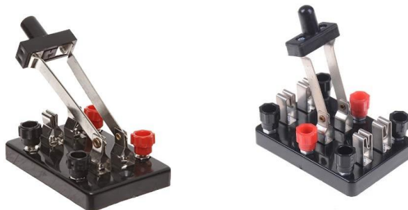
Figure 134 – Interrupteur bipolaire : unidirectionnel (gauche) et bidirectionnel (droite)
