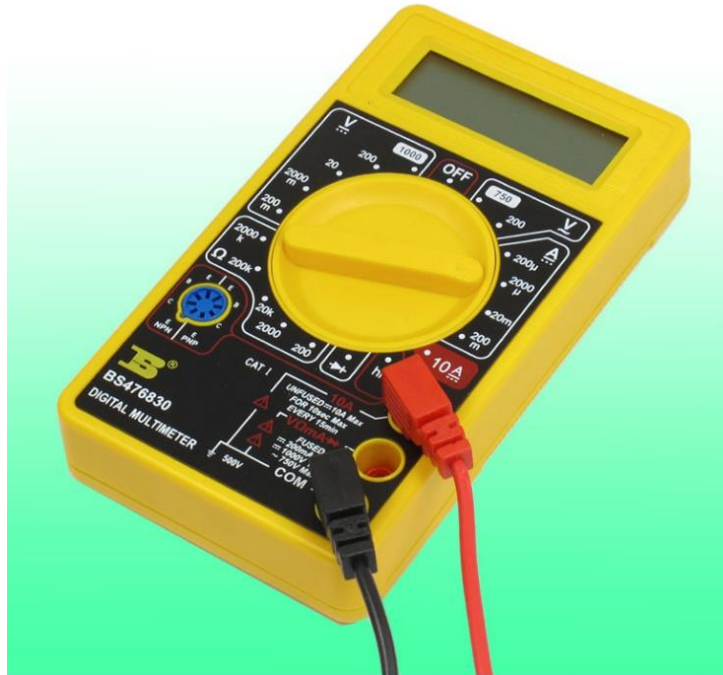
Schéma 2 – Réglage pour mesurer l'intensité du courant
